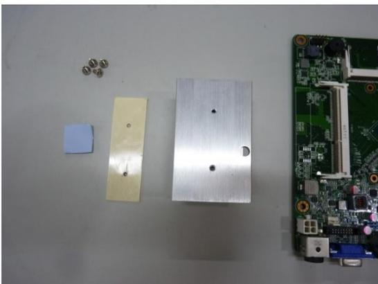
**Boulons d'espacement hexagonaux et plaquettes thermiques**
