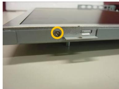
Vis de fixation du châssis
