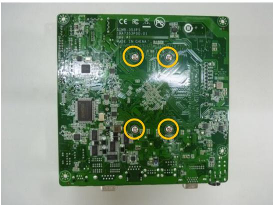
**Vis de fixation du dissipateur thermique (indiquées en jaune)**
