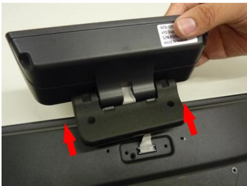
Retirez l'afficheur client VFD modulaire
