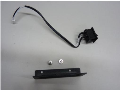
**Bouton d'alimentation principal, vis de fixation et support du bouton d'alimentation**
