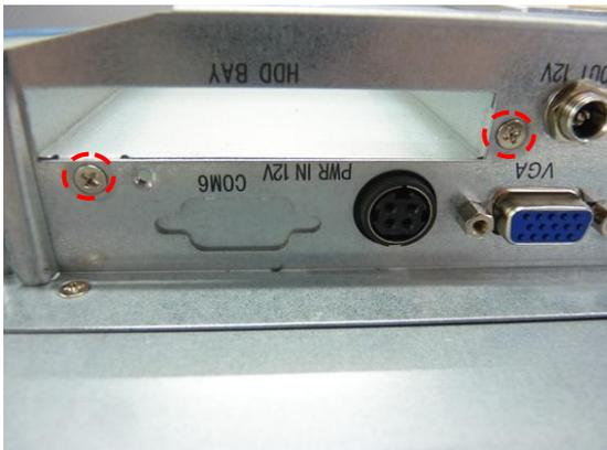
Vis de fixation sur le panneau des
