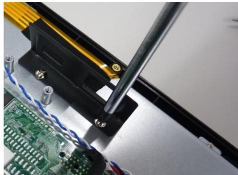
**Retirez les vis de fixation du support du bouton d'alimentation**
