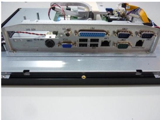
2. Retirez toutes les vis de fixation du panneau entrée/sortie inférieur
