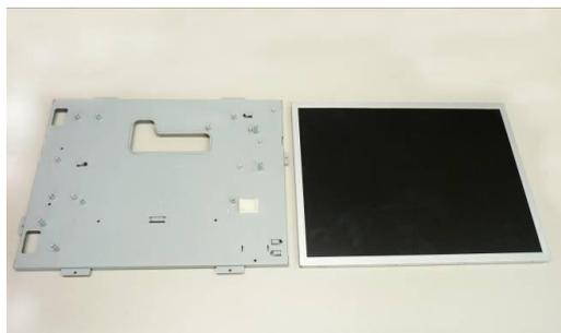
Châssis de l'écran LCD (à gauche) et Écran LCD
