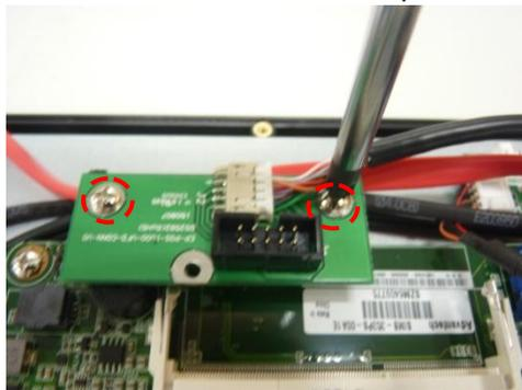
**Retirez les vis de fixation de la carte entrée/sortie supérieure**
