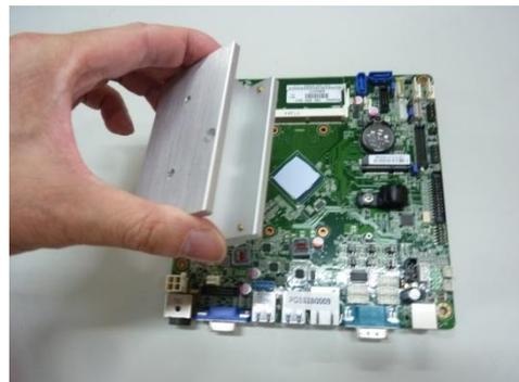
**Retirez le dissipateur thermique**
