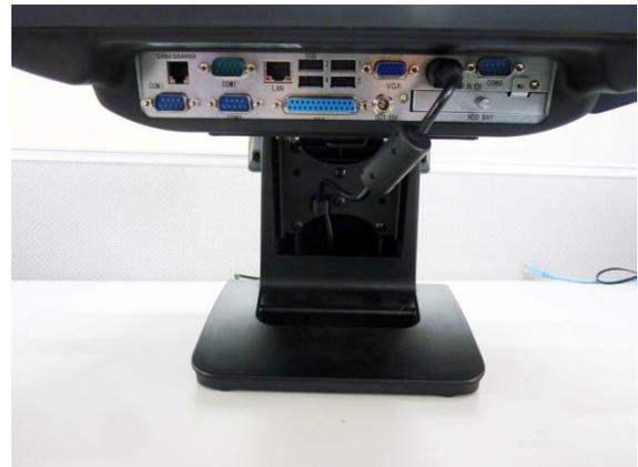
**Inclinez le TPV pour examiner les ports entrée/sortie situés dessous**
