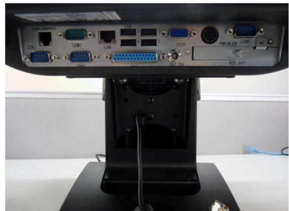
**Débranchez le connecteur de l'alimentation du panneau inférieur des entrées/sorties**
