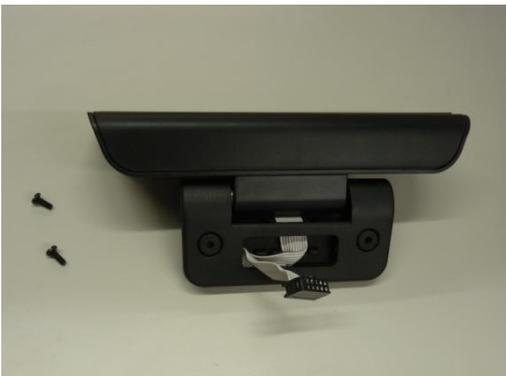
Afficheur client VFD modulaire
