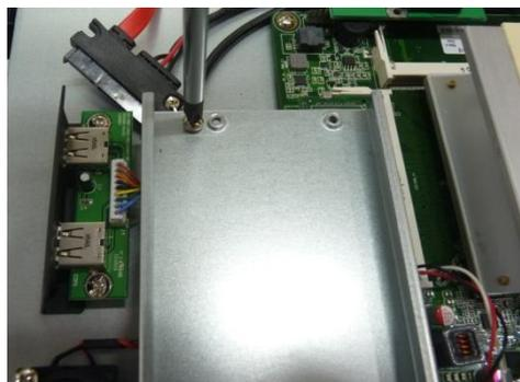
**c. Retirer la carte entrée/sortie supérieure (de l'afficheur client VFD modulaire)**
