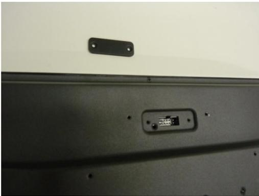
**Cache et connecteur entrée/sortie de l'afficheur client VFD**
