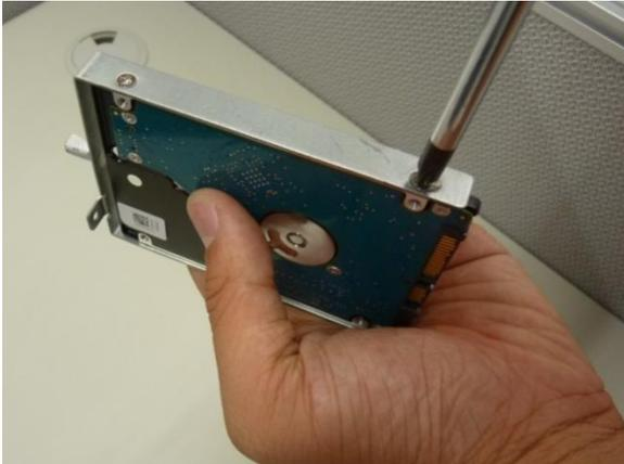
Retirez toutes les vis de fixation à l'aide d'un tournevis
