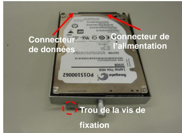
Placez un nouveau HDD / SSD dans le châssis
